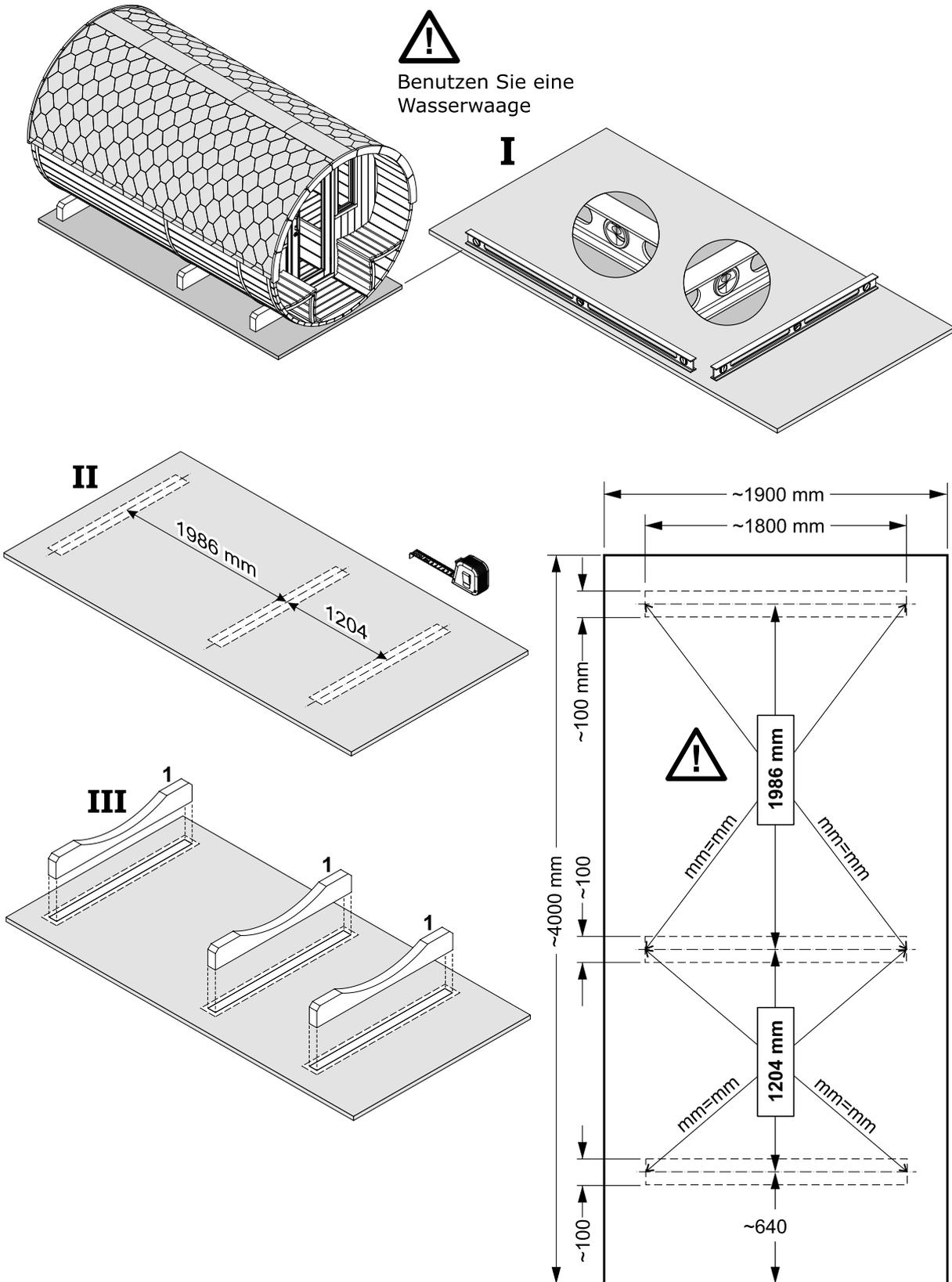
**Wir empfehlen ein vollflächiges Fundament: 1900x4000 mm**
