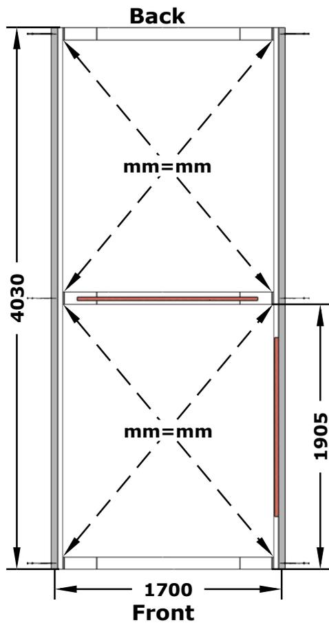
**Wir empfehlen ein vollflächiges Fundament: 4230x1900 mm**
