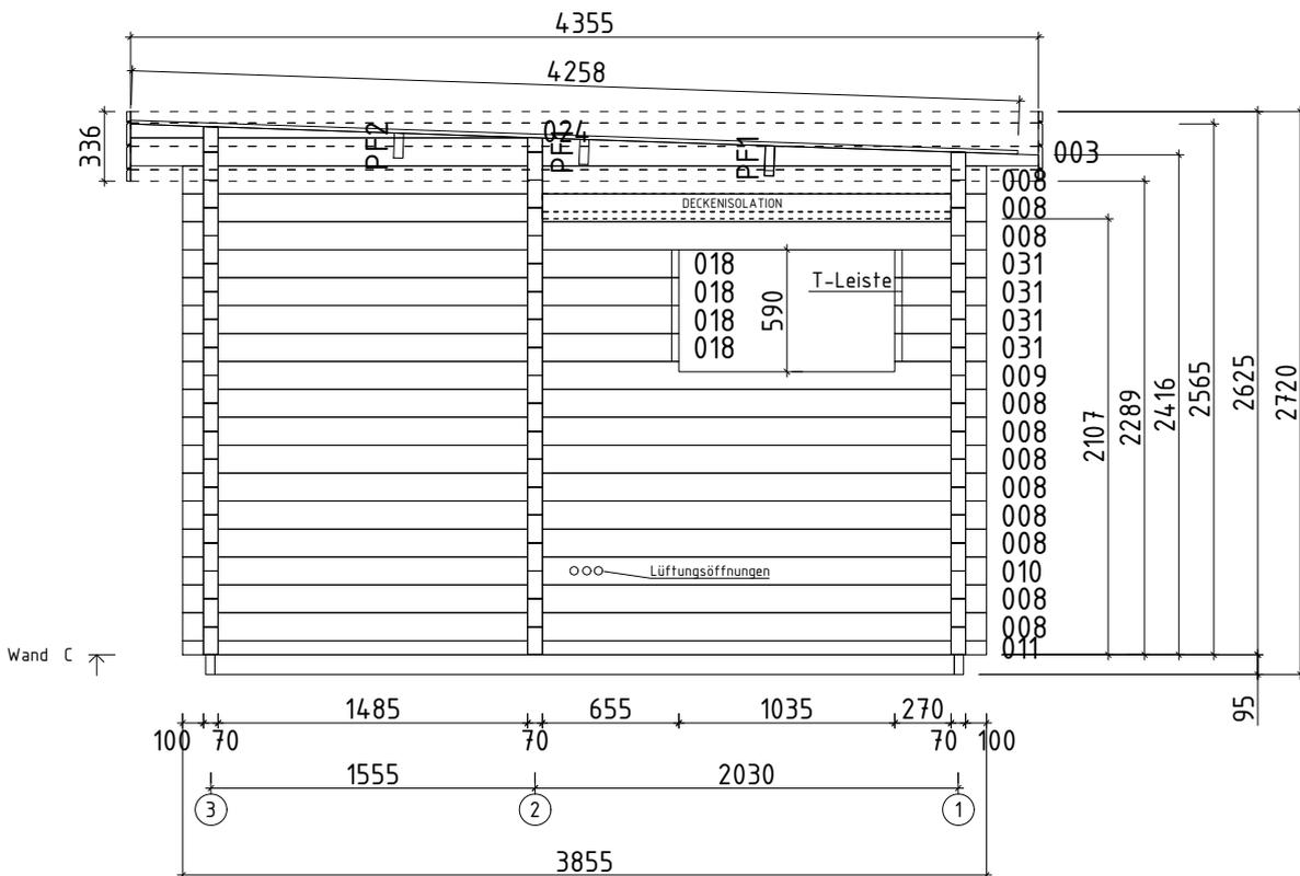
Die Bohlen mit Lüftungsöffnungen können je nach Bedarf höher oder niedriger eingesetzt werden. Bitte achten Sie darauf dass die Lüftungsöffnungen von innen nicht mit der Saunabank bedeckt werden!
