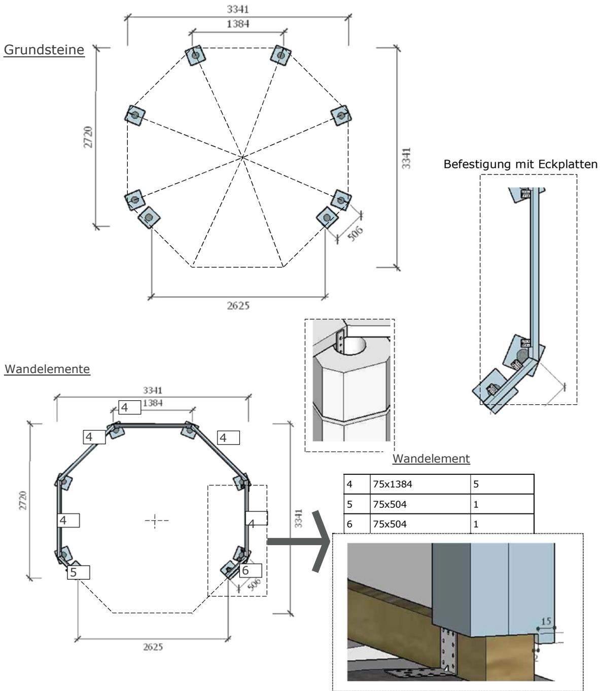
Für die Montage benötigtes Werkzeug: Wasserwaage, Hammer, Maßband, Schraubendreher (Bohrschrauber) Bohreinsätze on 4 mm, 8 mm, Dachmontageholz (z.B. 50x50 Länge 260 cm), Leiter
