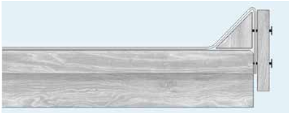
Ortgang mit Holzkeil und Windbrett mechanisch fixiert.
