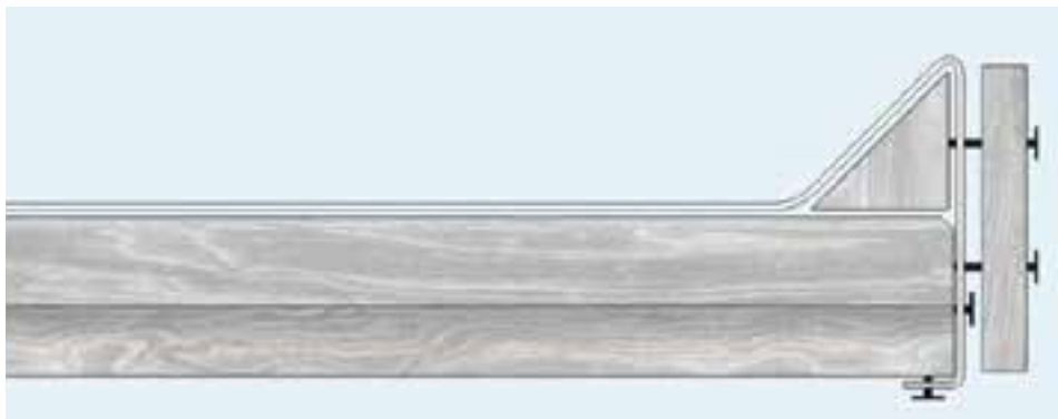
Ortgang mit Holzkeil und Windbrett mechanisch fixiert.
