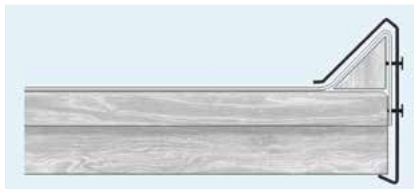
Ortgang mit Holzkeil und Metallabdeckung mechanisch fixiert.
