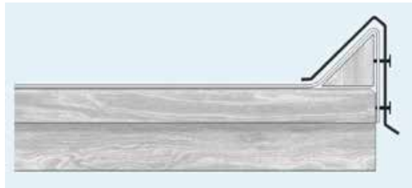
Ortgang mit Holzkeil und Metallabdeckung mechanisch fixiert.
