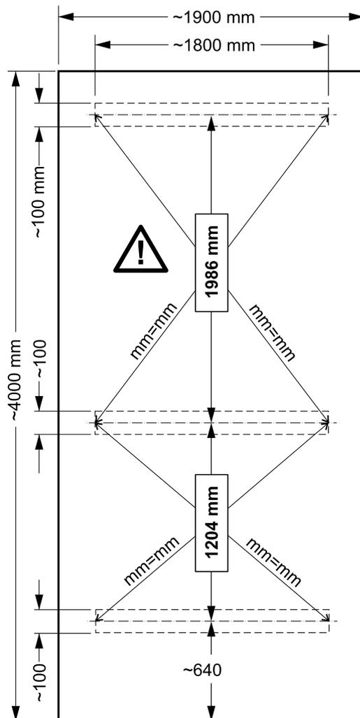
**Wir empfehlen ein vollflächiges Fundament: 1900x4000 mm**
