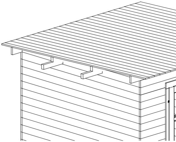
Falls kein Zubehör am Dach montiert werden soll, bitte die Enden der Dachbalken wie gezeigt absägen.
