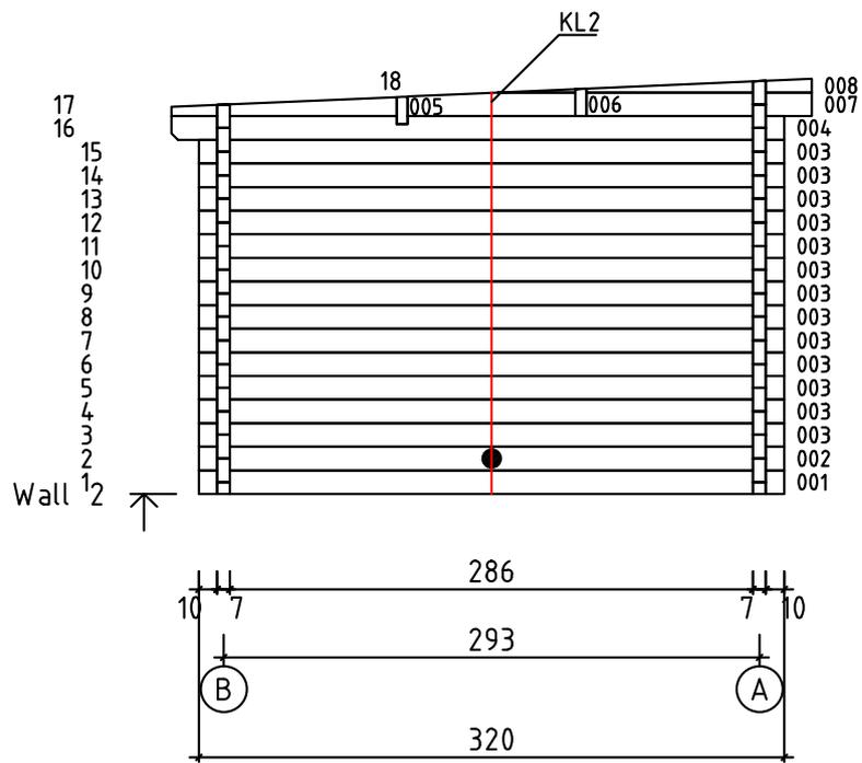
In diese Bohrungen müssen während der Montage nach jeweils drei Blockbohlenreihen Metallspindeln mit dem Durchmesser  $\varnothing 14$  mm x 390 mm Länge eingeschlagen werden.
