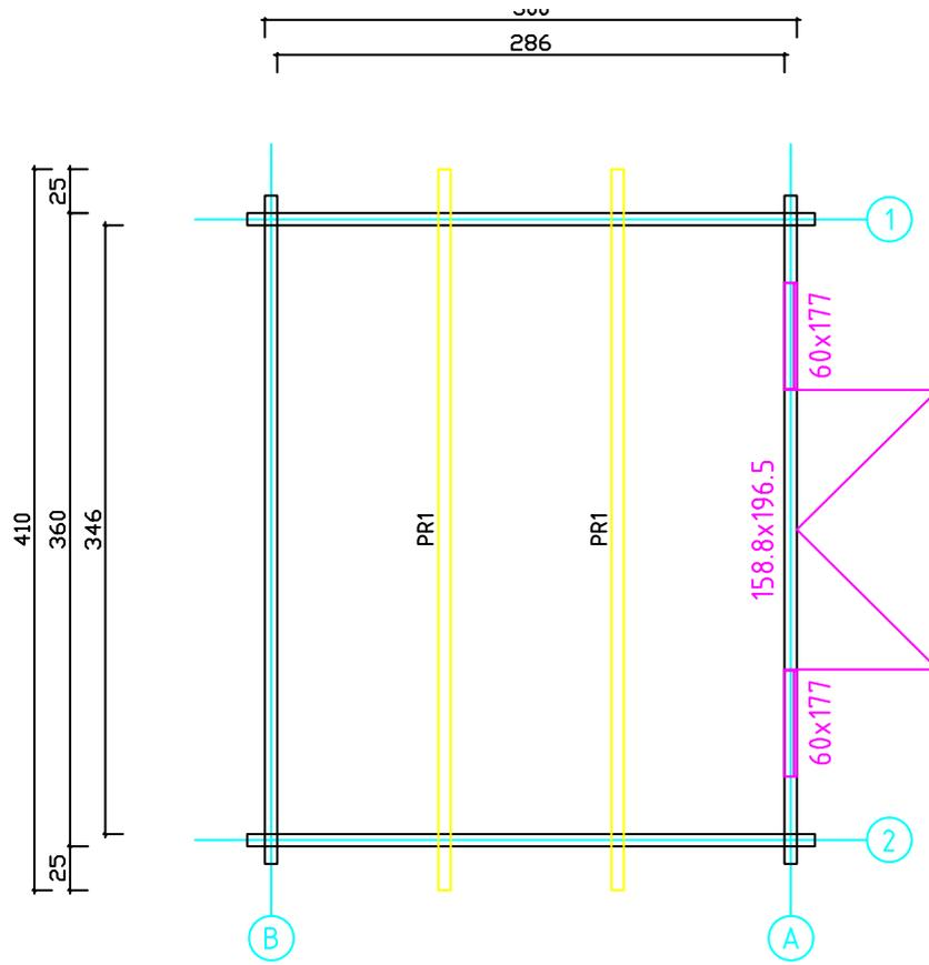
**Wir empfehlen als Fundament für Ihr Gartenhaus eine vollflächig festgegründete, gepflasterte oder betonierte Fläche. Wahlweise ist auch ein Punkt- oder Streifenfundament möglich.**
